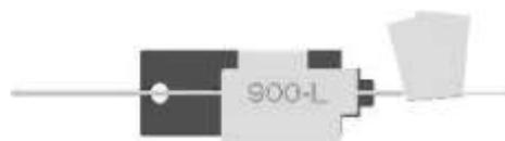
**NOTA:** el revestimiento de la fibra, tanto el de 250µm ó 900µm, debe sobresalir de los presores aproximadamente entre 1/2mm., tanto para la fusión como para la prueba de arco
