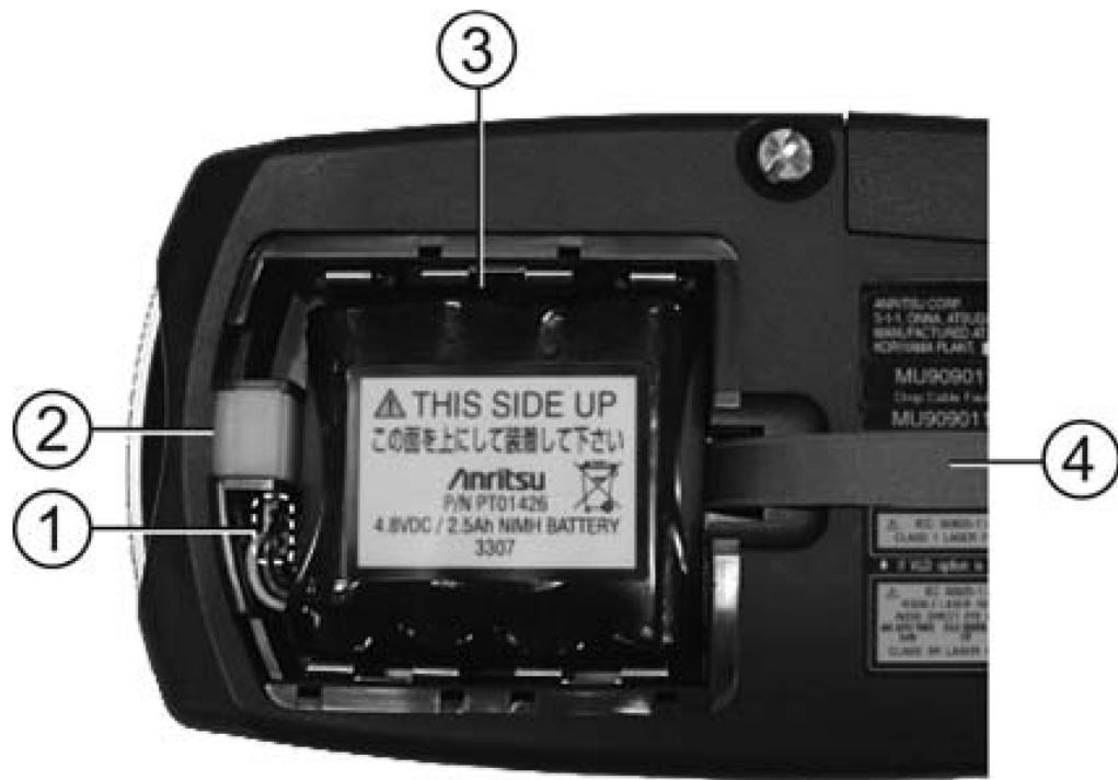
Figura 2-3: Compartimento de la batería abierto
