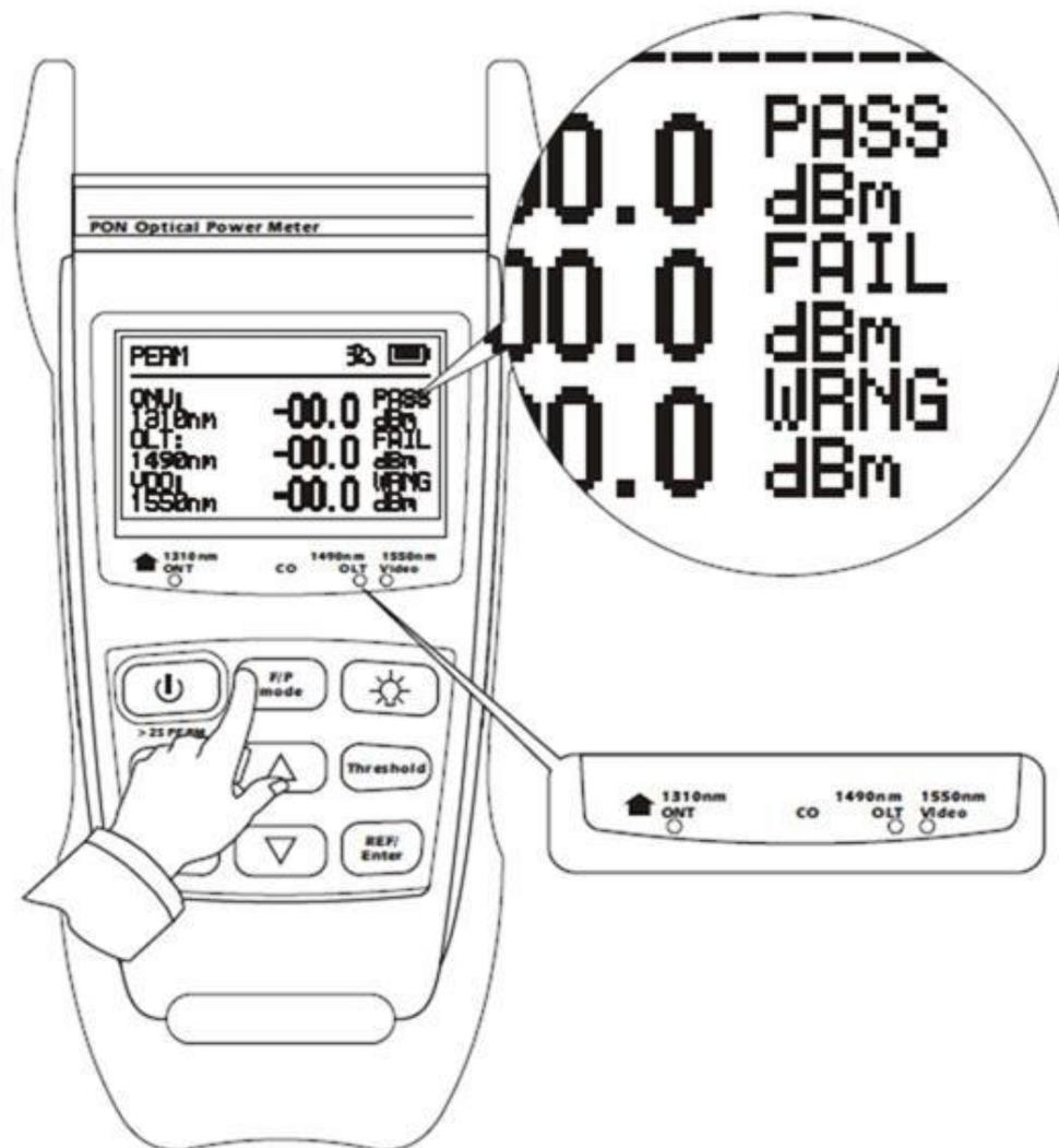
El modo Pasa / Falla, es un modo de trabajo sencillo y simplificado, ya que el instalador rápidamente puede visualizar si la instalación es correcta. Para cada una de las 3 longitudes de onda aparece a la derecha el indicador variable: Pasa (PASS); Falla (FAIL) y Alarma / Zona de funcionamiento dudoso (WRNG).
