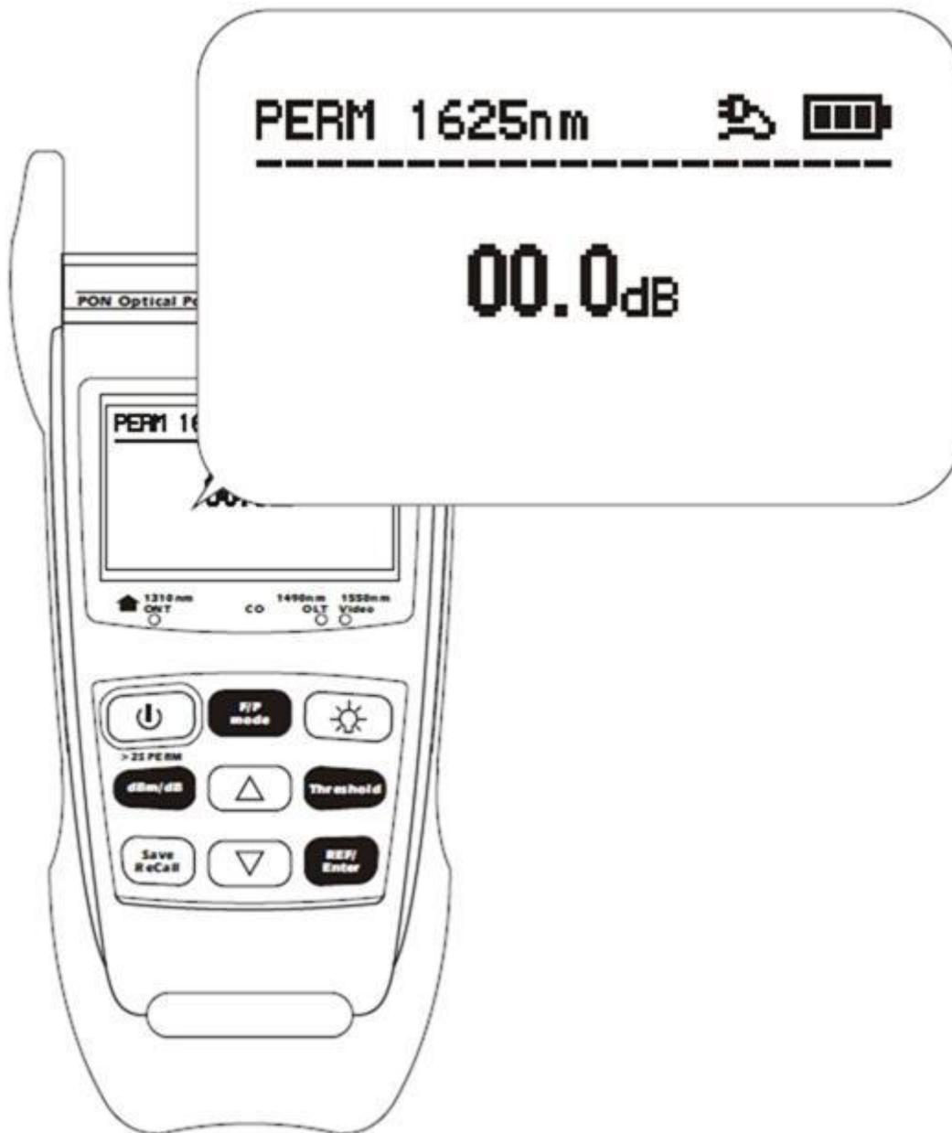
Estando en el modo test de medidas en redes PON, pulse la tecla F/P durante 2 segundos. Esto hará que el equipo cambie al modo OPM. Pulse de nuevo F/P para volver al modo de test de potencias en redes PON.
